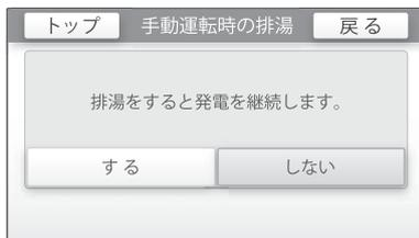
発電モードが「**手動**」で運転中に自動で排湯「**する**」・「**しない**」を設定。
