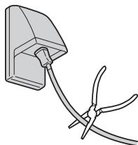
電源コードの届く範囲にコンセントがないときは、電力会社の指定工事店に依頼し、所定の電気配線をしてください。絶対に電源コードを切断して延長しないでください。火災や感電の原因になります。
