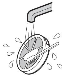
浴そうを掃除するときは、必ず循環アダプターもはずして歯ブラシなどでフィルターの汚れを掃除してください。ご使用時には必ず取付けてください。
