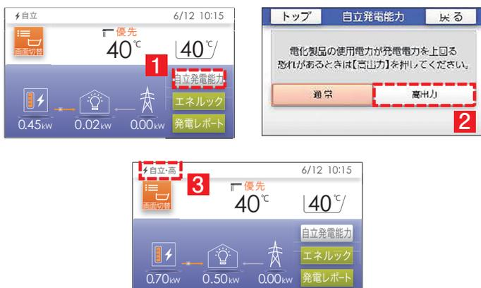
自立発電中、使用電力が少ない状態がしばらく続くと発電電力を下げる場合があります。使用電力の大きい電化製品を使用される場合は、以下の手順により発電出力を上げることができます。
